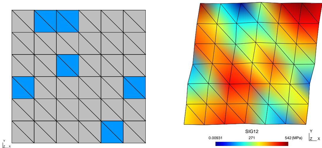
Figure 1 – (à gauche) maillage initial avec affichage en bleu de la porosité, (à droite) champ de contrainte de cisaillement sur la déformée
